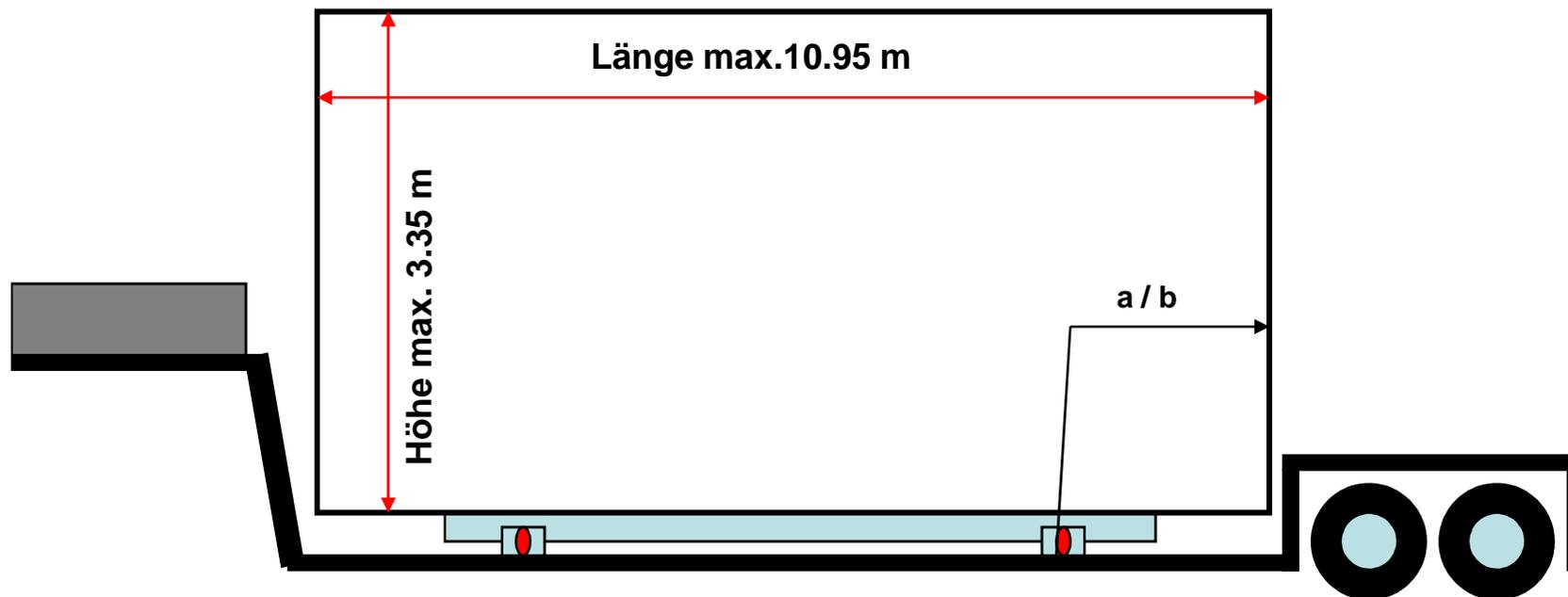
a: Überhang hinten 0.9m bei Elementlänge bis 9.5m
